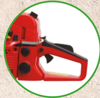
Botón de seguridad para accionar el funcionamiento
