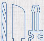
Brocas con borde cortante de un solo canal que asegura perforaciones redondas, permitiendo mayor control con menos vibración. Ideales para perforar metales ferrosos y plásticos.
